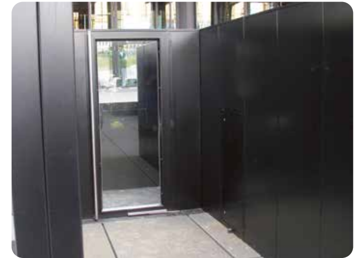
Einflügelige Tür: V2A fertiglackiert in RAL 9005, innenliegende Bänder, großflächig verglast, Stangengriff über die ganze Türhöhe, ohne Kämpfer
